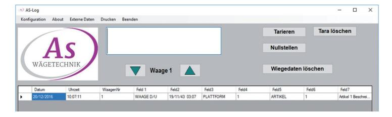
AS-LOG ist eine PC-Software, die Wägewerte in Echtzeit im PC erfasst und in einer Access Datenbank speichert.
