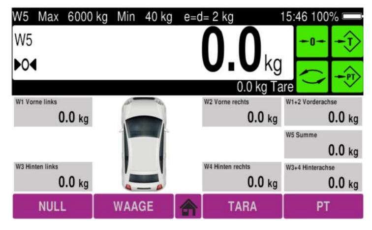
Die Waagenapplikation WHEELS ist ein umfangreiches Wäge-/Erfassungsprogramm für mobile, sowie auch für stationäre Radlastwaagen, verbunden mit Wägeterminal IT8000E, welches Kundenanforderungen vollständig angepasst werden kann.
