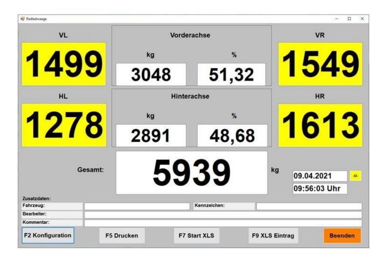
Die PC-Software **WinWheels** ist ein umfangreiches Wäge-/Erfassungsprogramm für mobile sowie auch stationäre Rad- und Achslastwaagen, welches nach Kundenanforderungen komplett angepasst werden kann. Die Software ist modular aufgebaut und kann daher kundenspezifisch erweitert/angepasst werden.
