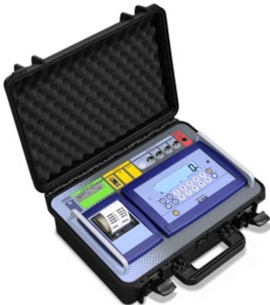
Multifunktioneller digitaler Wäge-Indikator im Baugruppenrahmen mit 4 Steckverbindern zum Anschluss an Plattformen. Mit interner wiederaufladbarer Batterie, Transportkoffer, Thermodrucker, Datum / Uhrzeit, Ladegerät. Ideal für Anwendungen wie mobile Fahrzeugwägung. CE-M eichfähig (OIML R-76 / EN 45501).
