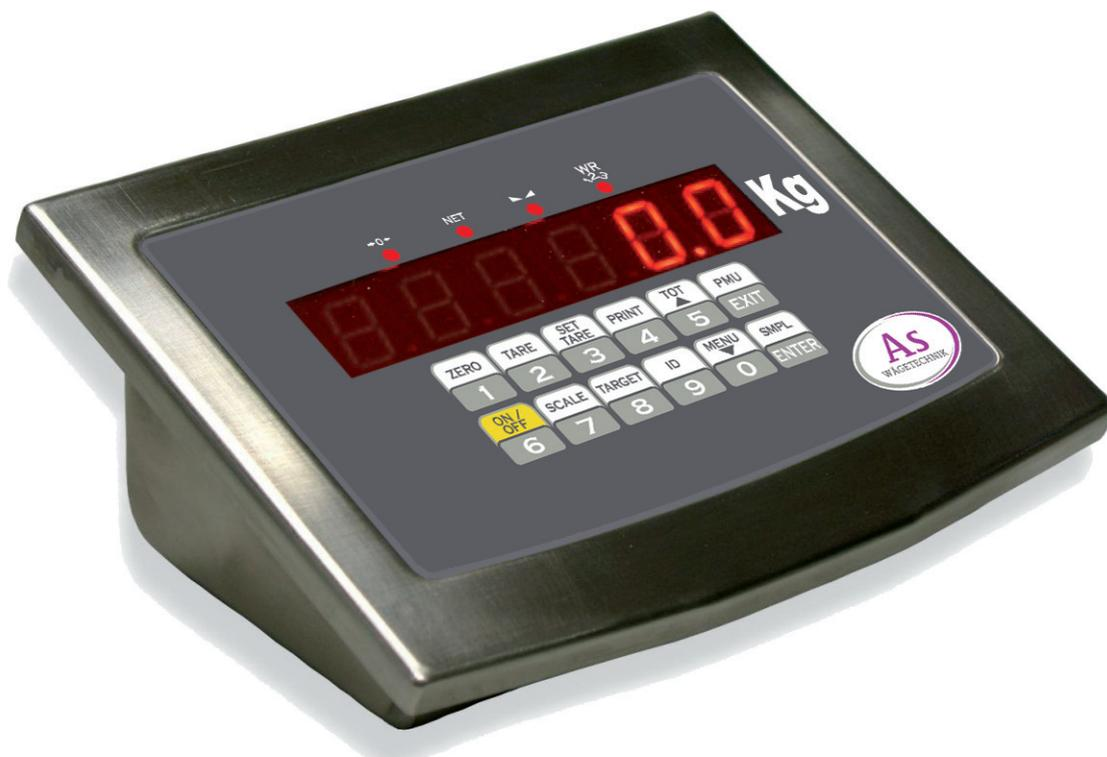
Multifunktionales Wägeterminal mit Gehäuse komplett aus Edelstahl AISI304, einer numerischen und funktionalen Folien-Tastatur mit 12 Tasten, und einem sehr leuchtstarken, roten LED-Display mit 20 mm hohen Ziffern, leicht ablesbar aus jedem Blickwinkel und großer Entfernung, auch bei direktem Sonnenlicht.
