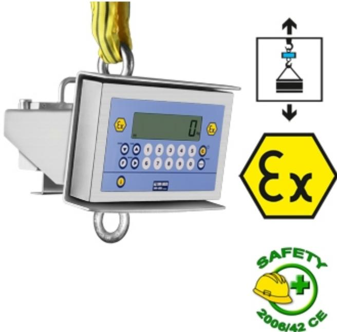
Kranwaagen, klassifiziert für Wäganwendungen in explosionsgefährdeten ATEX-Bereichen (Zone 1 und 21, 2 und 22), mit Schutzart gemäß Ex II 2G IIC T4 Gb X und Ex II 2D IIIC T197°C Db X.
