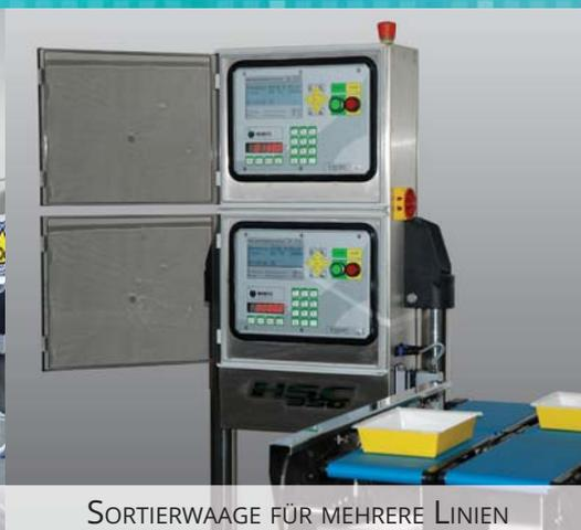
SORTIERWAAGE FÜR MEHRERE LINIEN
