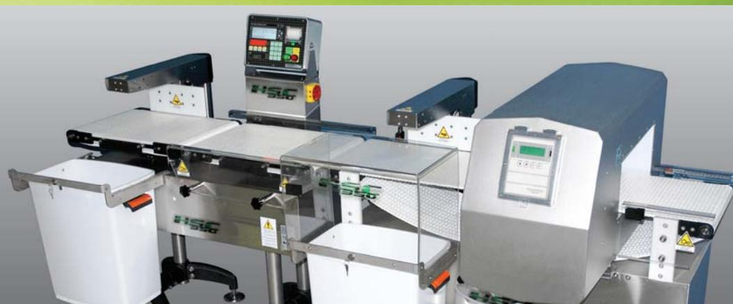
SORTIERWAAGE UND METALLDETEKTOR FÜR BEUTEL
